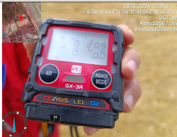
Fotografía No. 2: Multimetro usado para monitoreo de gases
